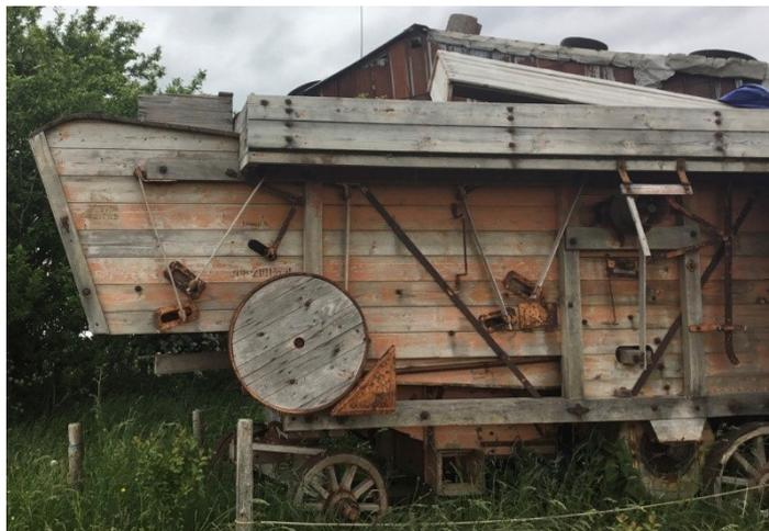
Bild 8: Dreschkasten. Wurde ab Mitte der 1950er Jahren zum Dreschen des Getreides, d.h. dem Trennen der Körner von den Ähren verwendet.
