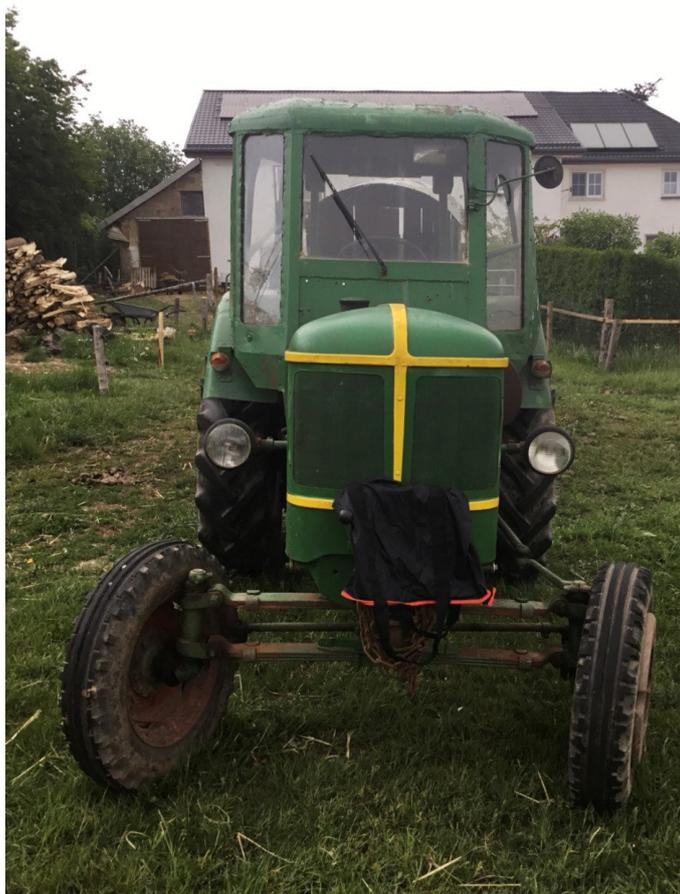
*Bild 16: Trecker. Dies ist ein Deutz D40 Baujahr 1959. Er dient als Beispiel, um einen Eindruck der damaligen Leistung der Trecker zu geben. Er ist ein mittel-starker Schlepper.*
