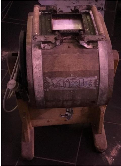
Bild 12: Butterfass (von Miele). Wurde zum „Drehen von Butter“ genutzt. (Genauere Beschreibung im Text).
