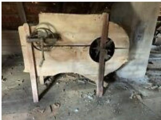
Bild 7: Fauch. Gerät zum Reinigen des Getreides nach der Ernte.
