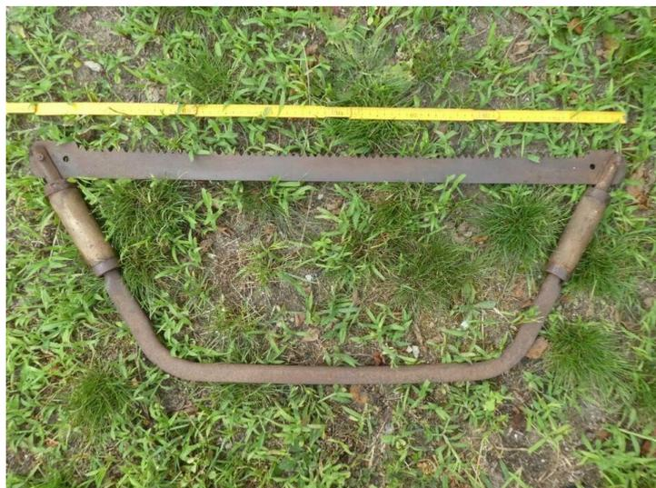
Bild 10: Ramsäge (Auch Bügelsäge genannt). Wurde zum Zuschneiden von Brennholz verwendet.
