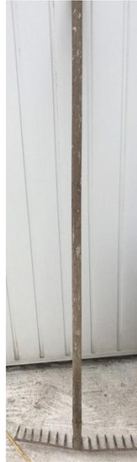
Bild 13: Herkel. Rechenartiges Gerät wird zum Glattziehen der Erde verwendet.
