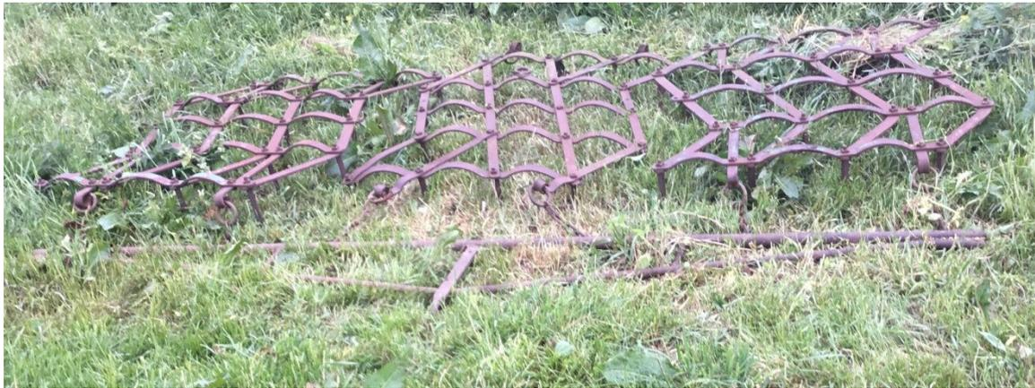
Bild 4: Egge. Dieses Gerät dient zum Eggen, also zum Auflockern des Bodens und Zerkleinern der Erdklumpen.
