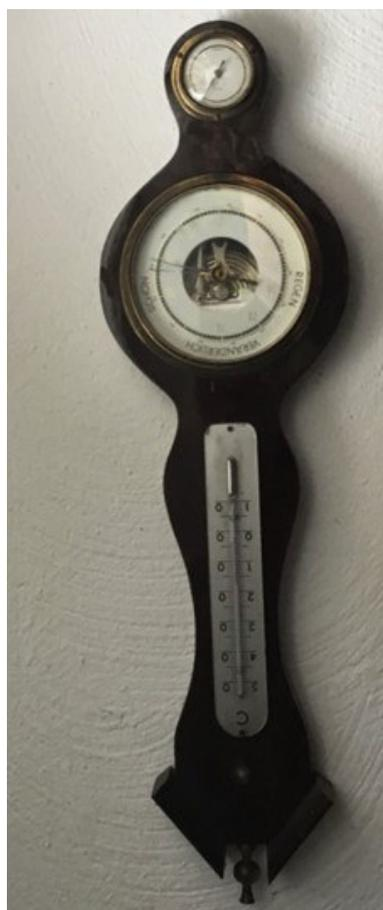
*Bild 1: Barometer. Dies dient zum Ablesen von Wetterprognosen und Luftdruck.*
