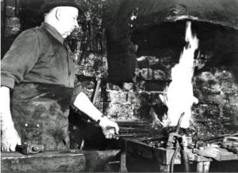
Abb. 1: Johann Ronig erhitzt am lodernden Schmiedefeuier ein Hufeisen. In der rechten Hand den Schmiedehammer: „Man muss das Eisen schmieden, solange es heiß ist“.
