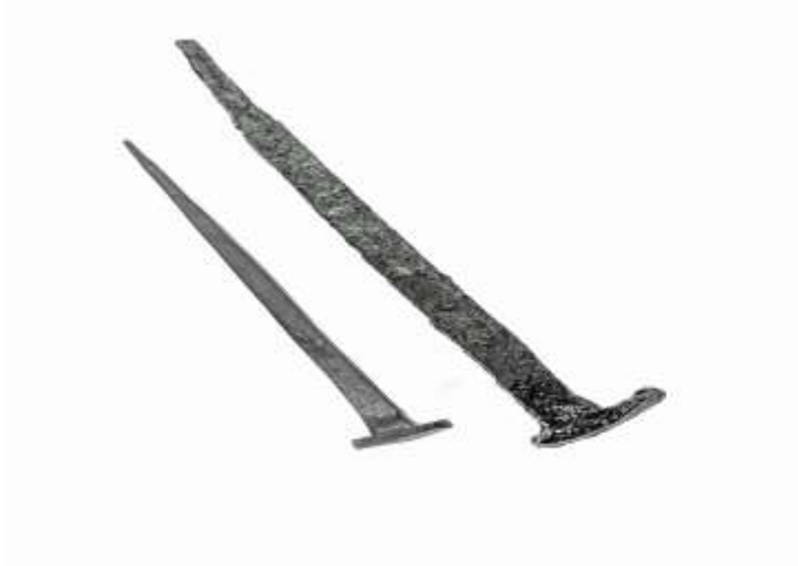
Bild 1: Römischer Nagel groß um 300 n.Chr. und ein neuzeitlicher Nagel klein. aus dem 21. Jahrhundert mit der Hand geschmiedet, Länge 16,5 cm.
